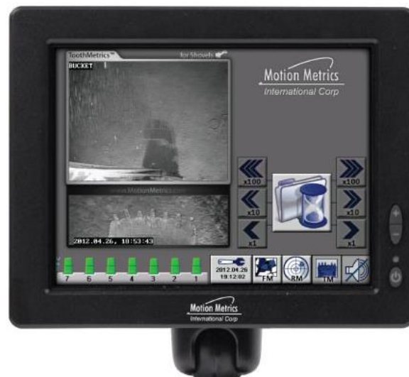
Figura 7-8. Consola de pantalla de monitoreo de los dientes del balde
