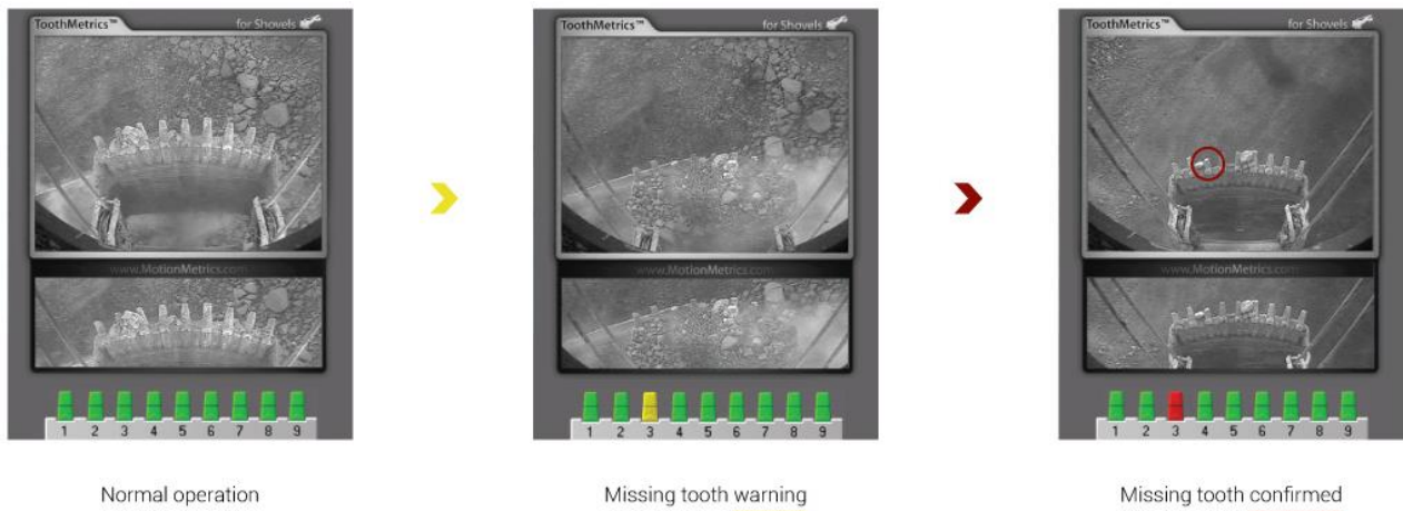
Figura 7-9. Detección en tiempo real de la caída de dientes
