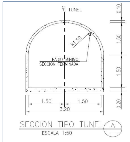
Figura 9: Sección Aguas Arriba, Túnel EVH
