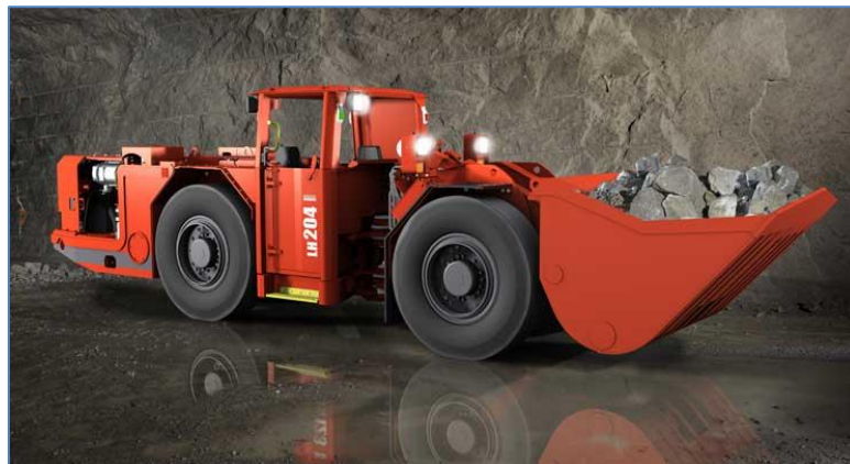
Figura 4: Maquinaria retiro de marina, Scoop
