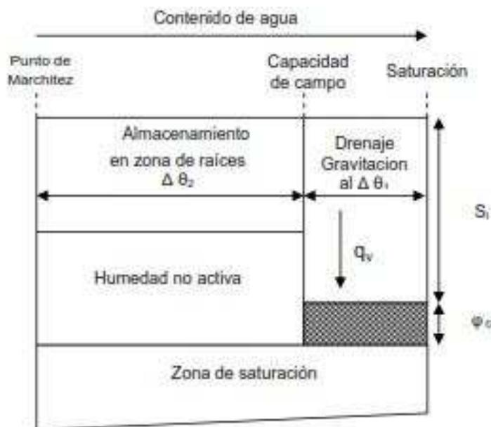
Figura 2.4: Esquema vertical de los elementos de almacenamiento. Fuente: Singh *et al.* (1995).
