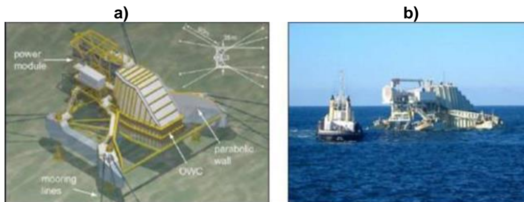
Figura N°A.7 a) Esquema y dimensiones Energetech (fuente Previsic 2004) b)Planta piloto Energetech (fuente Energetech 2007)
