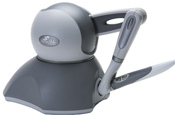
Figura 3.12: Dispositivo de interfaz háptica Phantom Omni de la empresa Geomagic . Imagen obtenida de [64]
