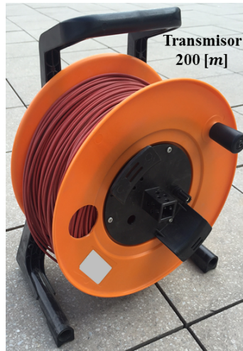
Figura 4.2: Carrete de 200 [m] de cable utilizado como parte del loop transmisor.
