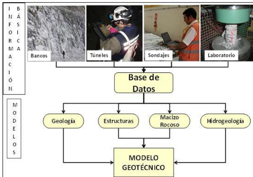
Figura 5.6 Esquema fuentes de información geotécnica para generación de modelos
