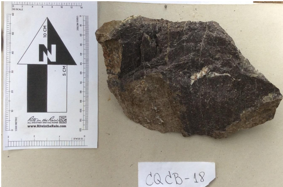
Figura 39: Muestra de mano CQCB-18. Al igual que en el afloramiento, se observan espacios rellenos por cuarzo con leves cantidades de epidota.
