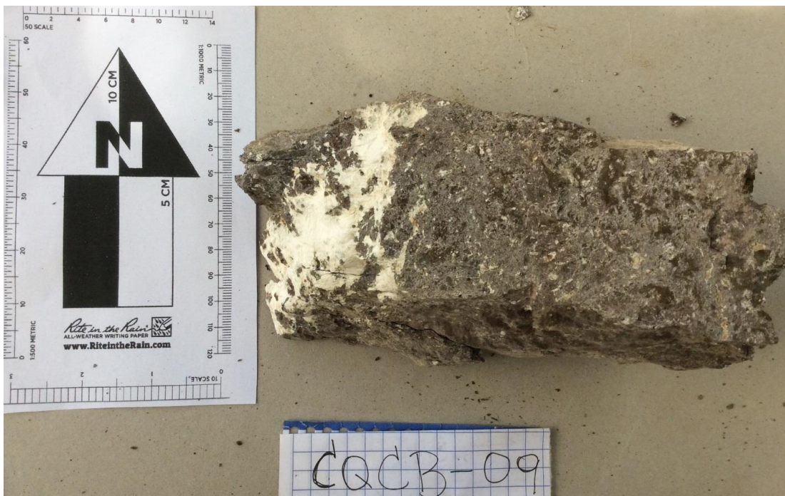
Figura 44: Muestra de mano CQCB-09. Se observa bastante alterada y con el mineral blanco siendo identificado como laumontita.
