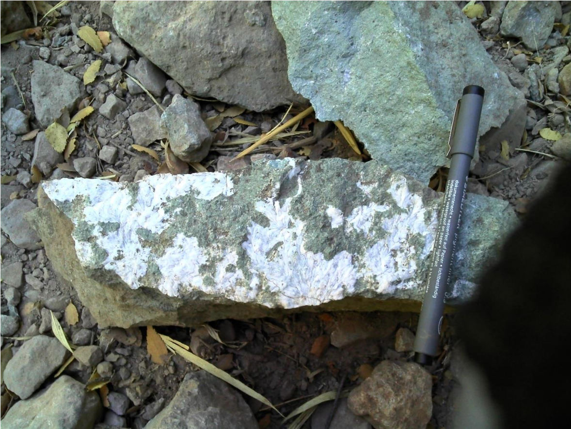
Figura 34: Muestra de mano correspondiente al afloramiento CQCB-25. Se reconoce un mineral blanco de alteración, identificado como wairakita mediante DRX.
