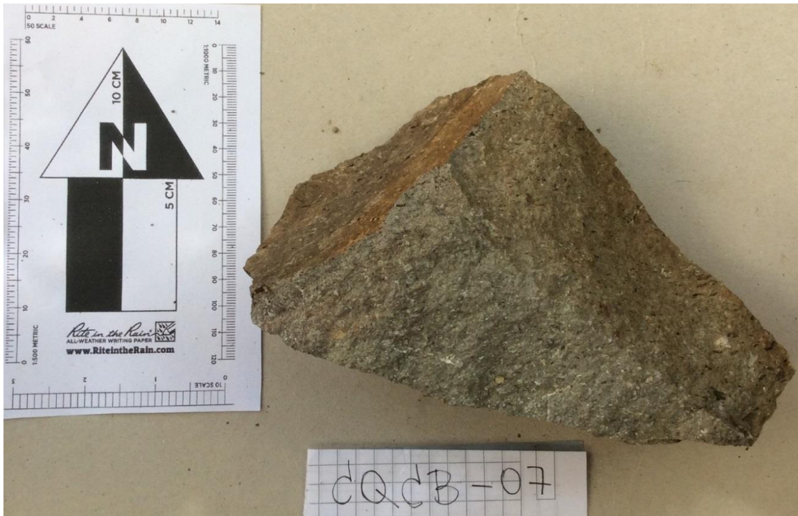
Figura 49: Muestra de mano CQCB-07. Se logran distinguir fenocristales de feldespatos y algunas amígdalas.
