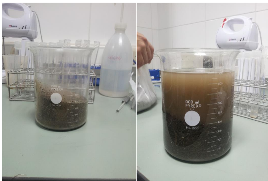
Figura 6: Vaso precipitado con muestra de roca, agua y Calgon para realizar la separación de arcillas.
