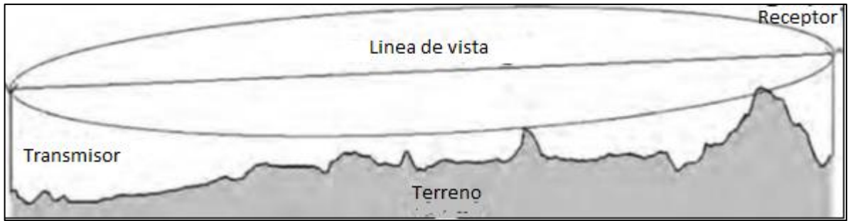
Ilustración 10 Transmisión en línea de vista y elipsoide de Fresnel
