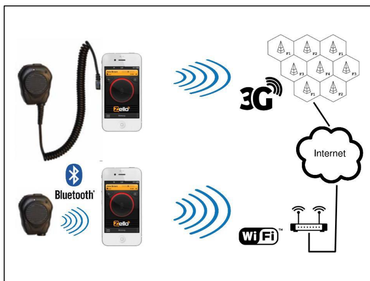
Ilustración 52 Esquema funcionamiento aplicación Zello
