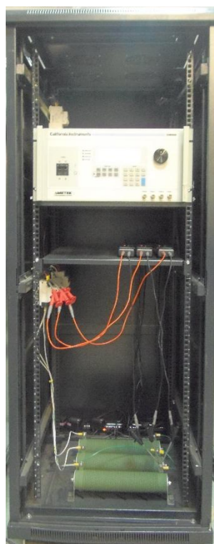
Figura 7.13. Fuente de poder programable modelo CSW5550.
