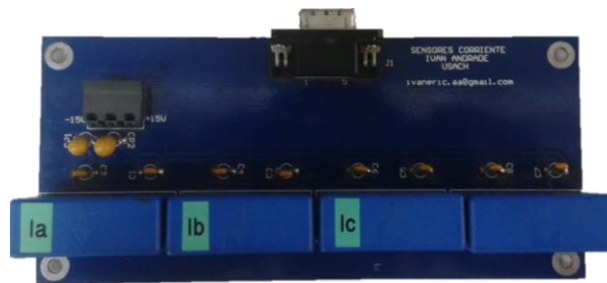
Figura 11.6. Tarjeta de transductores de corriente LEM LA 55-P.
