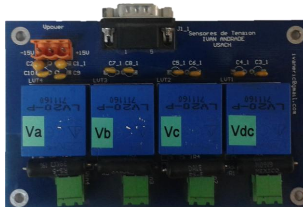
Figura 11.4. Tarjeta de transductores de tensión LEM LV 20-P.
