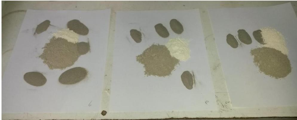
**Figura 53: Preparación de fase sólida para reometrías.**
