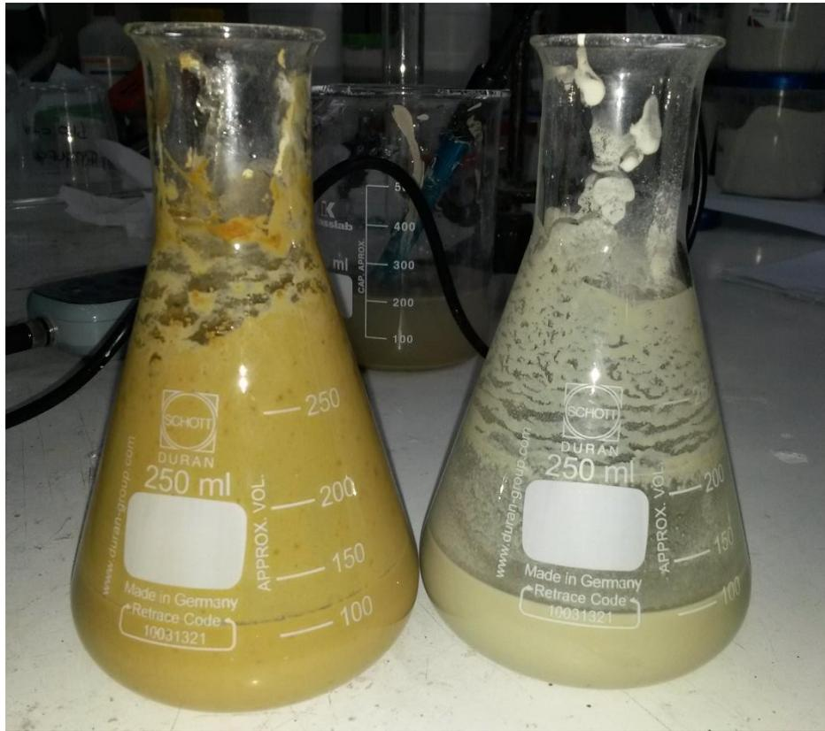
**Figura 85: Cambio de color en suspensión de montmorillonita pura. Muestra con pH 10.87 (izq.) y pH 1.81 (der.).**
