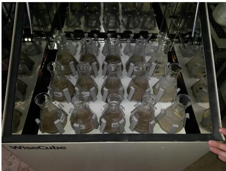
**Figura 55: Mezclas ubicadas en agitador.**
