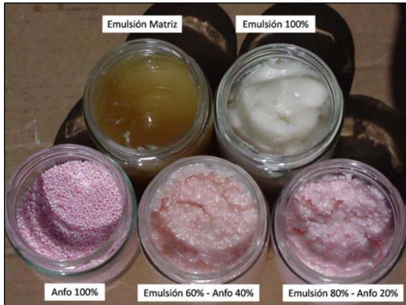
Ilustración 9. Diferentes tipos de emulsión en función de la proporción Emulsión/ANFO.
