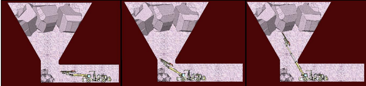
Ilustración 44. Procedimiento de descuelgue con Jumbo de Descuelgue.
