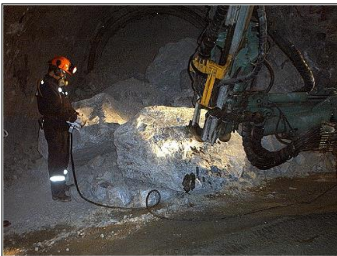
Ilustración 30. Cuadrilla reduciendo bolones agrupados por acopio.
