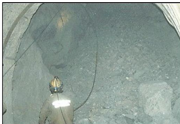
Ilustración 42. Procedimiento de descuelgue manual.
