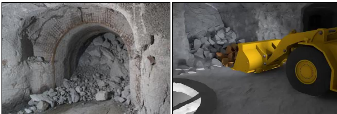
Ilustración 3. Punto de extracción. Imagen real de un punto de extracción (izquierda) y animación del proceso productivo (derecha).
