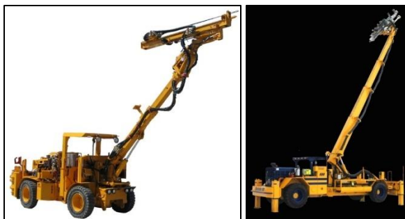
Ilustración 43. Jumbos de Descuelgue. Equipo SB9, empresa MacLean (Izquierda) y equipo BH40D, empresa RDH (Derecha).
