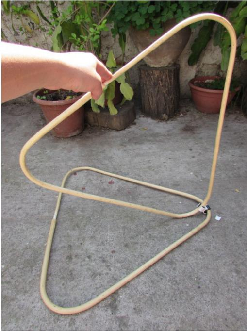
Para realizar una unión por intersección se realizó un vínculo que respondiera a ello. Sin embargo al momento de utilizarlo, el vínculo sufrió rotura. Esto es producto del sentido de impresión del filamento en 3D.
