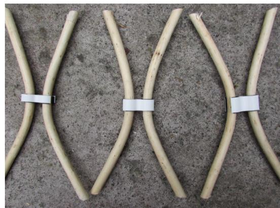
Se realizó otro diseño formal de abrazadera, con curva y contra curva pero que no funcionó, ya que resultó ser muy flexible, no contribuyendo en la resistencia.
