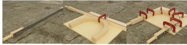
Imagen 18. Curvado con banda de apoyo. En: Manual para el curvado de madera y MDF.
