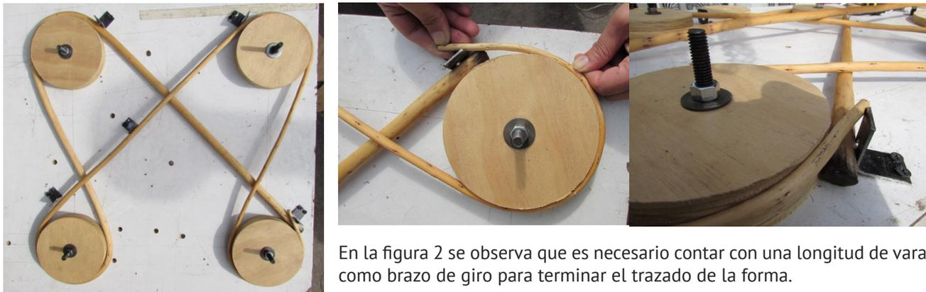
En la figura 2 se observa que es necesario contar con una longitud de vara como brazo de giro para terminar el trazado de la forma.
