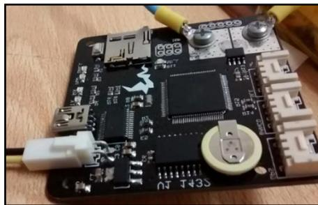
FIGURA 2.6.6: CIRCUITO MAESTRO DE ADQUISICIÓN Y TRANSMISIÓN DE DATOS
