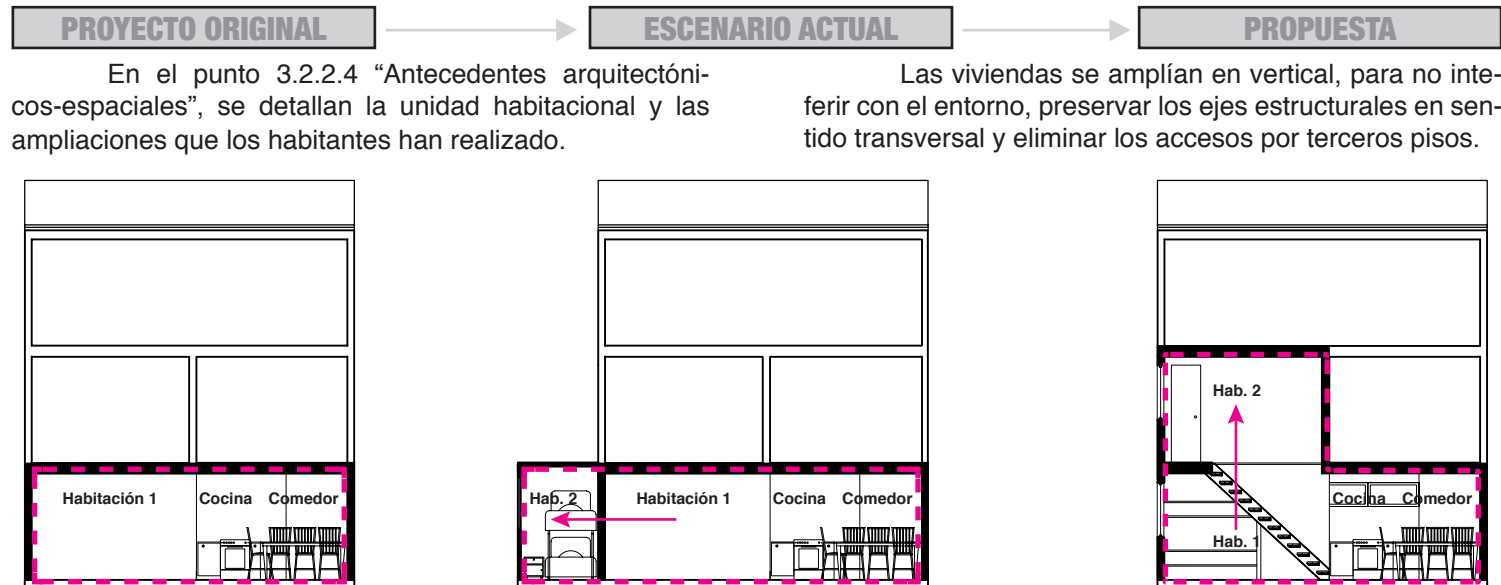
Figura 45: Corte de vivienda, según sus fases, hasta la Propuesta de Rehabilitación Fuente: Elaboración propia
