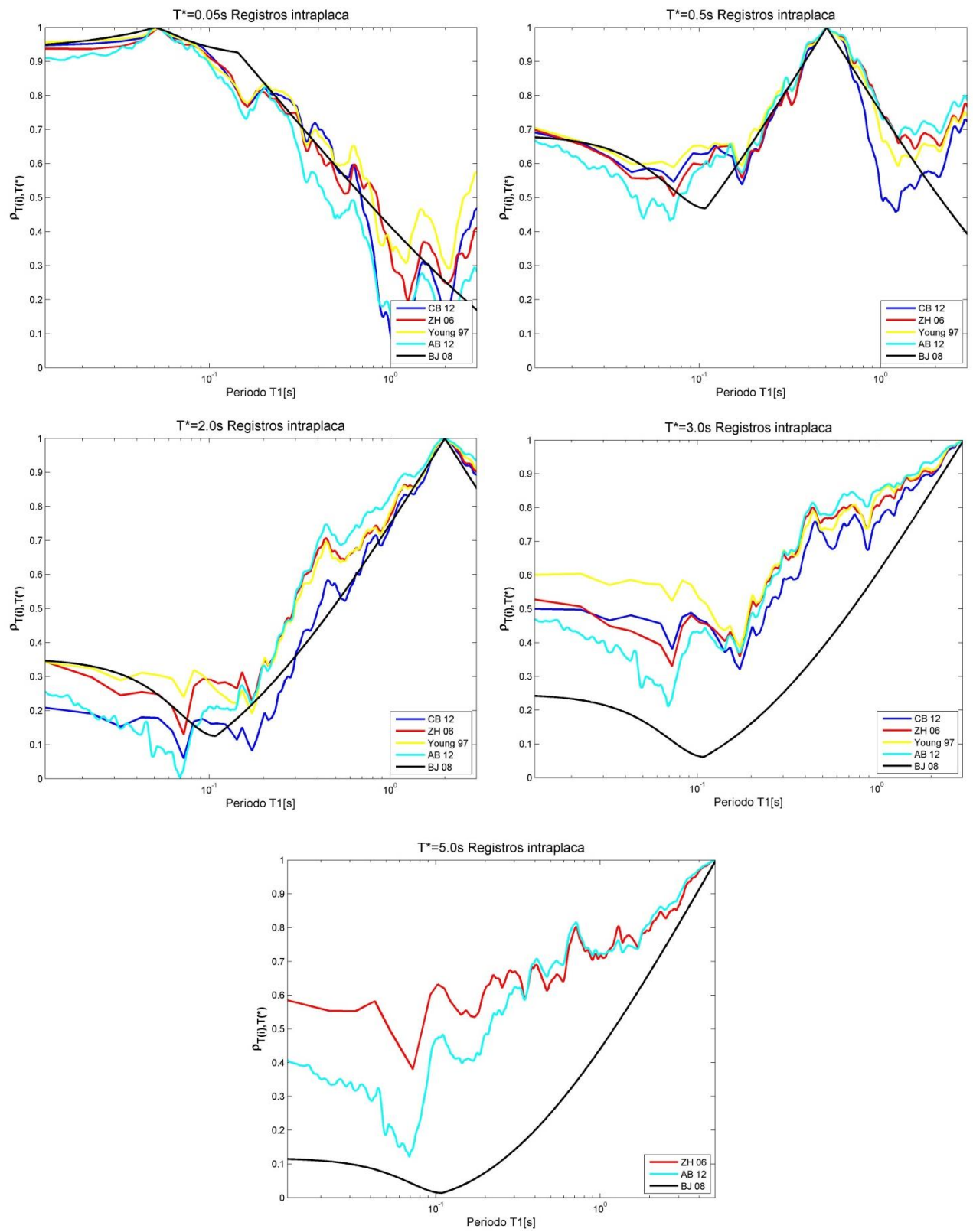
Figura 92: Factores de correlación para registros Intraplaca con periodos fijos de: Arriba izquierda: T^*=0.05s . Arriba derecha: T^*=0.5s . Centro izquierda: T^*=2.0s . Centro derecha: T^*=3.0s . Abajo: T^*=5.0s .
