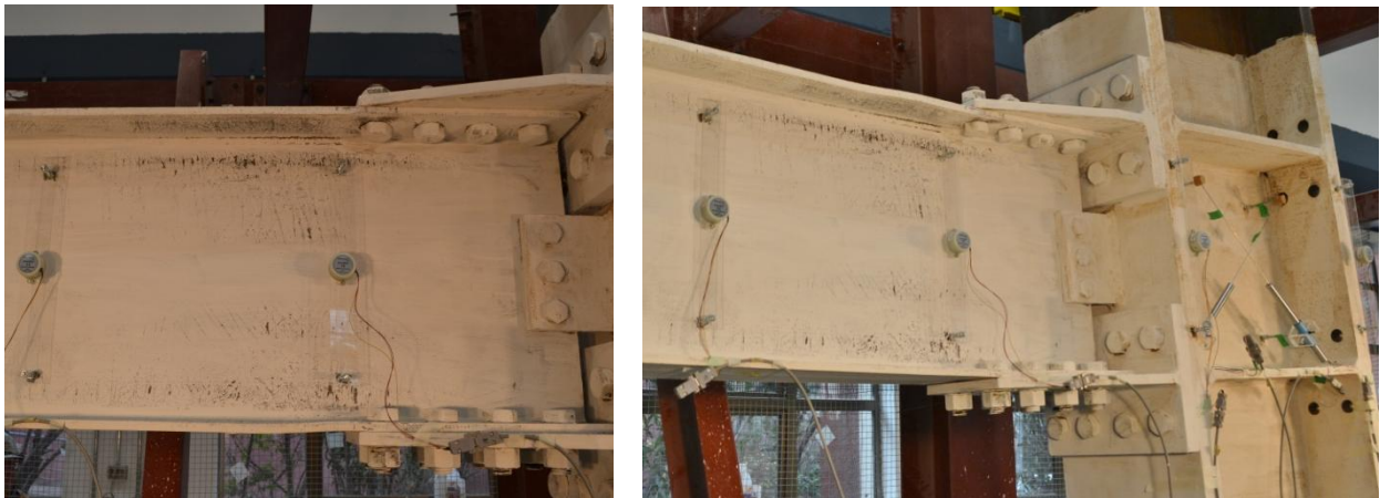
Figura 6.20: Inicio de pandeo local en las alas de la viga para \theta=0,04 [rad].
