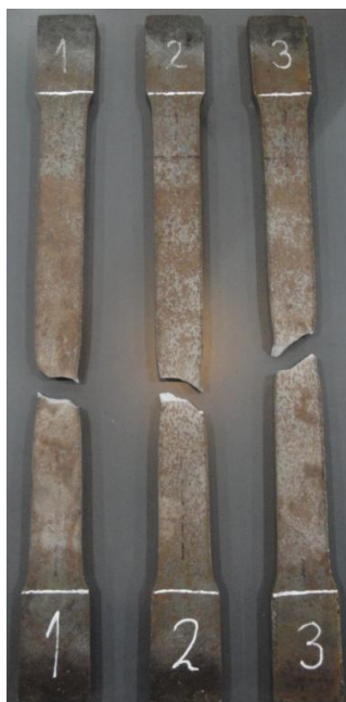
Figura 4.5: Probetas planas de espesor 12 [mm] post-ruptura.
