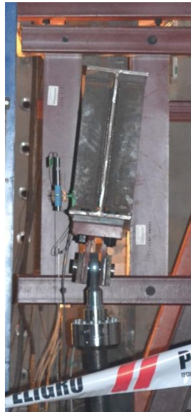
Figura 6.9: Volcamiento en la viga este del espécimen SE-01, para \theta=0,04 [rad].
