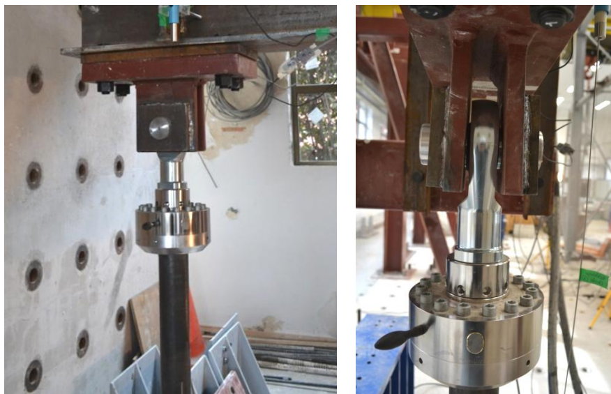
Figura 5.12: Celda de carga para medir la reacción en vigas.
