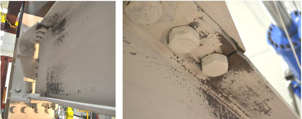
Figura 6.38: Inicio de fractura del área neta de la viga en T-stub superior, para \theta=0,05 [rad] (ciclo 2).
