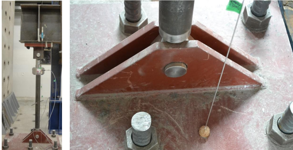
Figura 5.9: LVDT que mide el desplazamiento vertical del apoyo de cada viga.
