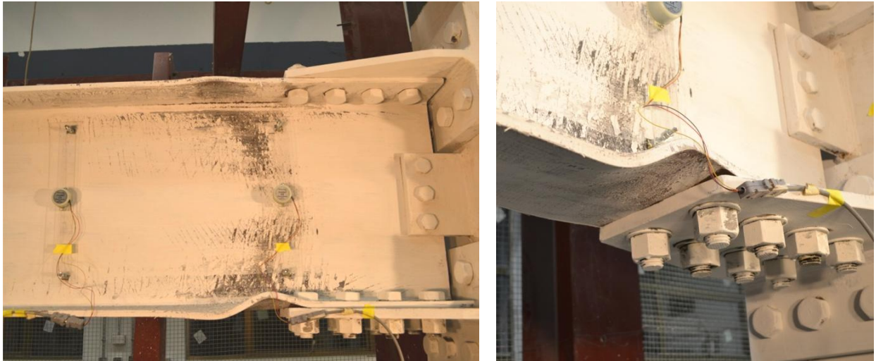
Figura 6.37: Deformación en el espécimen SE-02(b) para una distorsión de piso \theta=0,05 [rad] (ciclo 2).
