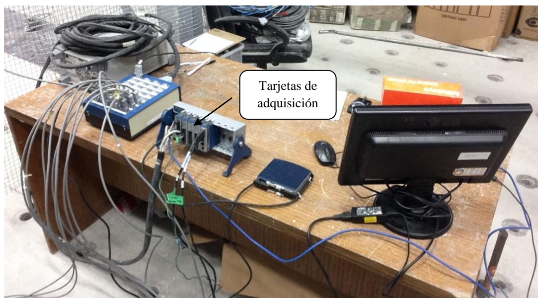
Figura 5.14: Sistema de adquisición de datos – vista trasera.
