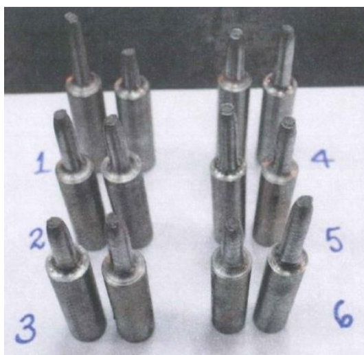
Figura 4.6: Probetas ensayadas por SCI post-ruptura (Apéndice B).
