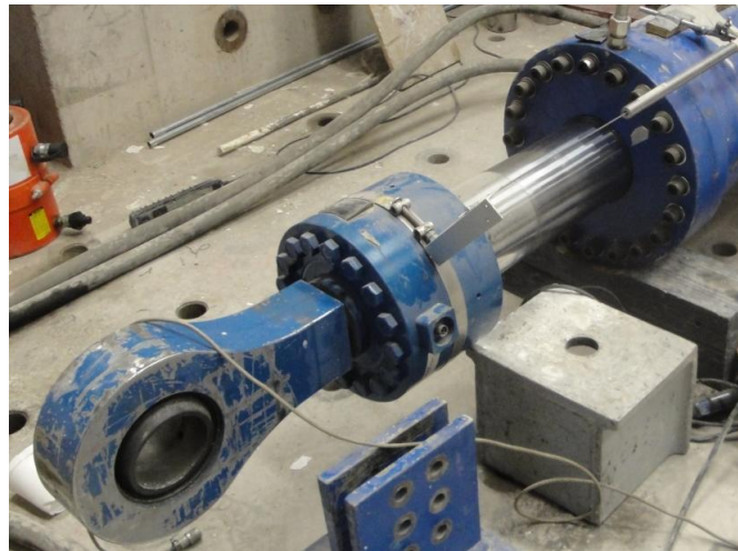
Figura 5.11: Celda de carga del actuador hidráulico.
