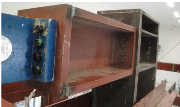
Figura 5.15: Pieza rectificada para garantizar la completa carrera del actuador en ambos sentidos.
