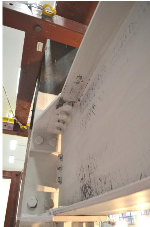
Figura 6.34: Estado de la viga y conexión para \theta=0,04 [rad] (ciclo 2).
