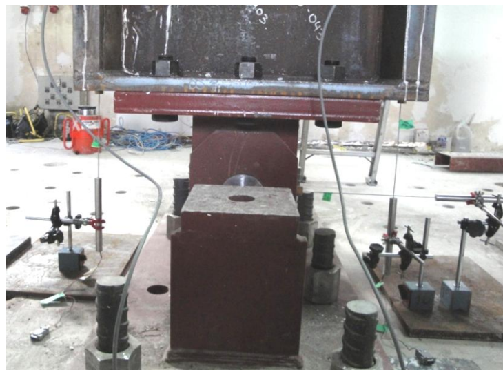
Figura 5.10: LVDTs que registran el desplazamiento vertical y horizontal de la base de la columna.
