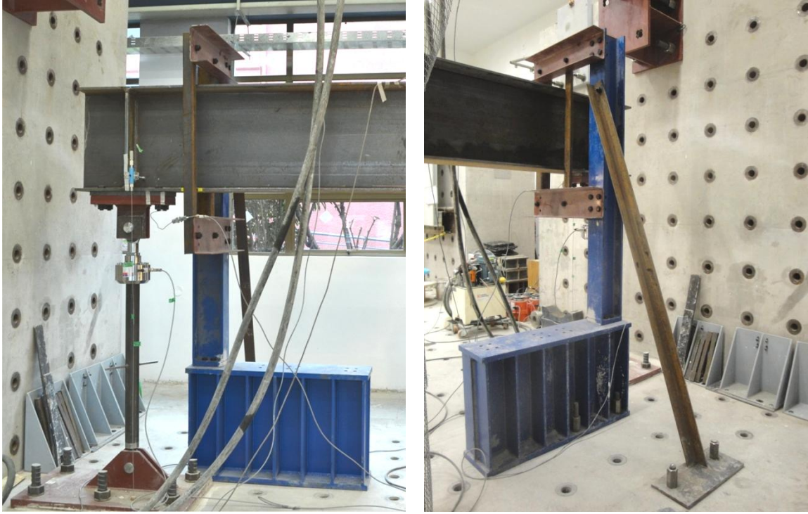
Figura 5.16: Restricción lateral adicional para cada viga.
