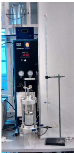
Figura 4.11: Equipo utilizado en ensayos de permeabilidad a carga variable y pared flexible.
