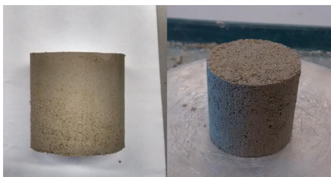
Figura 4.14: Muestras talladas para cálculo de índice de vacíos inicial: a) Probeta 5: Obtenida a partir de la muestra de dos ciclos de depositación, capa superior (Zona 1, Figura 4.2) y b) Probeta 6: Obtenida a partir de la muestra de tres ciclos de depositación, capa inferior (Zona 6, Figura 4.3).
