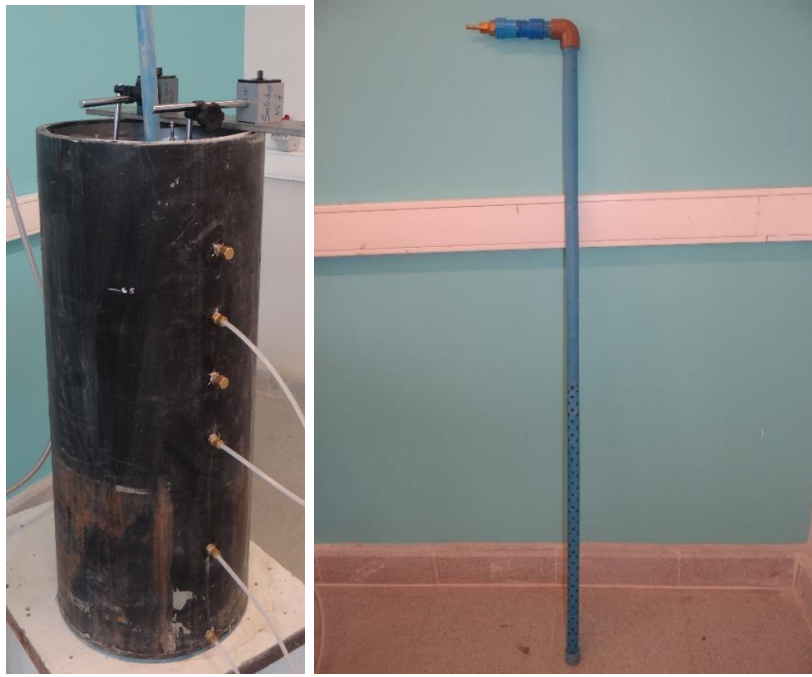
Figura 5.3: Contenedor cilíndrico de suelo depositado y dren utilizado para transmitir la succión en la profundidad de la columna de relaves.
