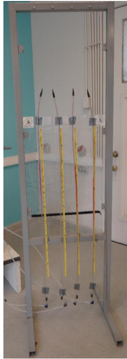
Figura 5.5: Panel piezométrico utilizado para registrar la presión de poros.
