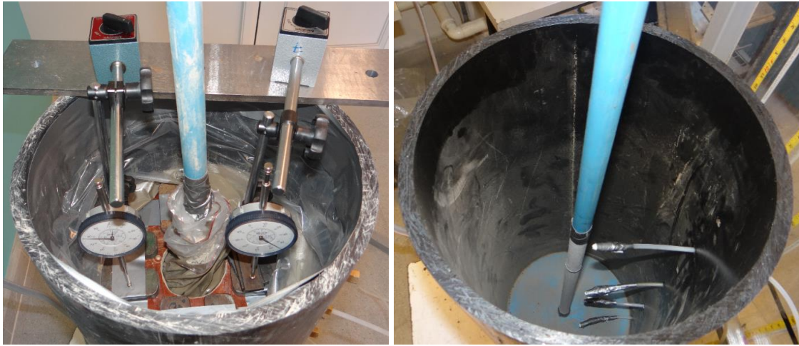
Figura 5.4: Tapa hermética superior e instalación de diales para registrar deformación vertical e Instalación de piezómetros al interior del contenedor.
