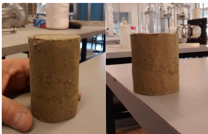
Figura 4.12: Probetas para ensayos de permeabilidad: a) Probeta 1, con capa superior de finos y b) Probeta 2, sin capa superior de finos.
