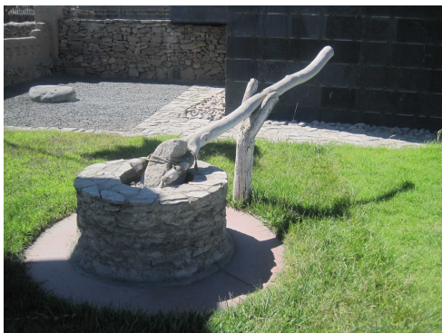
Maray, herramienta para triturar el mineral
