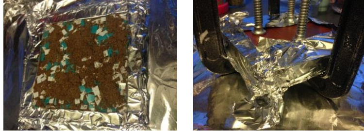
Figura 31: a. Mezcla en molde. b. Molde prensado. Elaboración propia.
