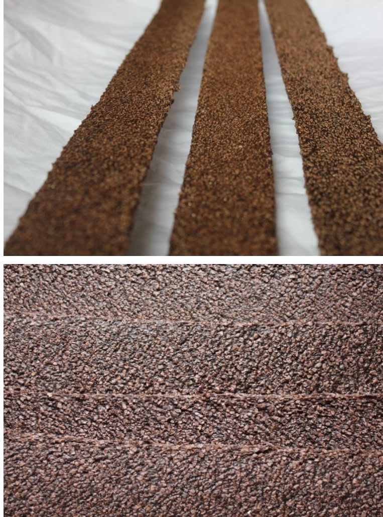
Figura 64: a. perfiles extruídos de muestra CD2. b. Detalle de los perfiles extruídos. Elaboración propia.
