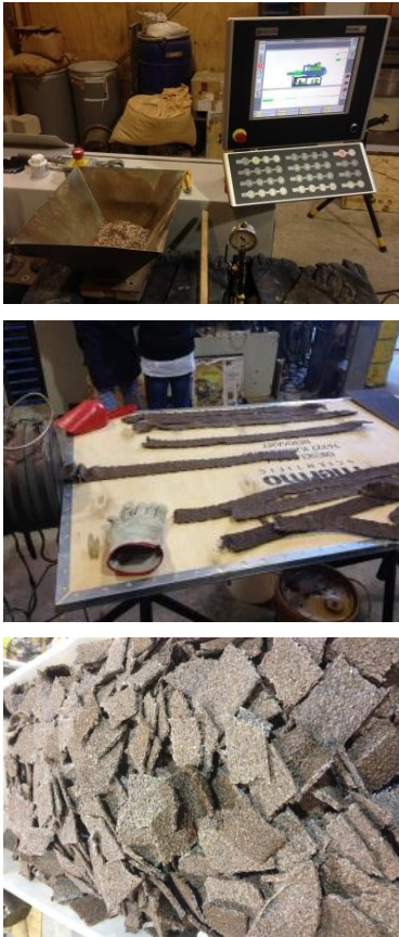
Figura 36: a. Muestra en zona de alimentación de extrusora. b. Perfiles obtenidos. c. Perfiles cortados. Elaboración propia.
