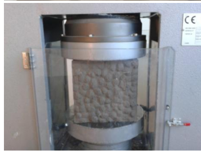
Figura 15: a. Tamizado de carozos. b. Conformación del hormigón. c. Curado del hormigón. c. Ensayo de material (StoneFruitFloors, 2015).
