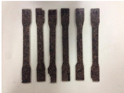
Figura 47: a. Corte de probetas con router CNC. b. Probeta durante el ensayo de tracción. c. Probetas antes de ser ensayadas. Elaboración propia.
