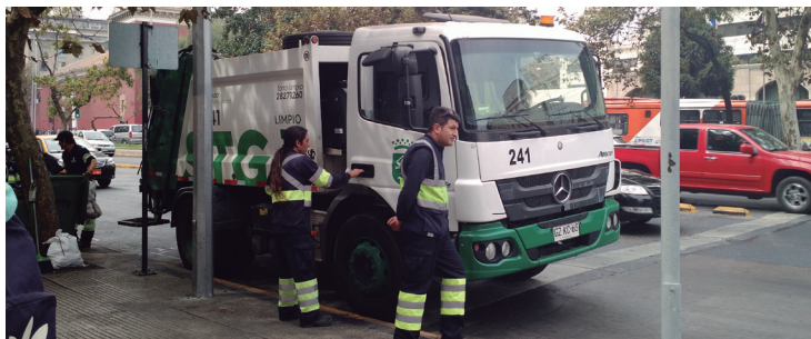
Camión compactador pequeño. Santiago. Elaboración propia.
