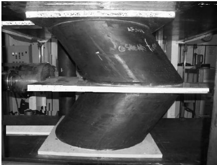
Figura N°12, Reproducción de Ensayo de Deformación horizontal máxima.
