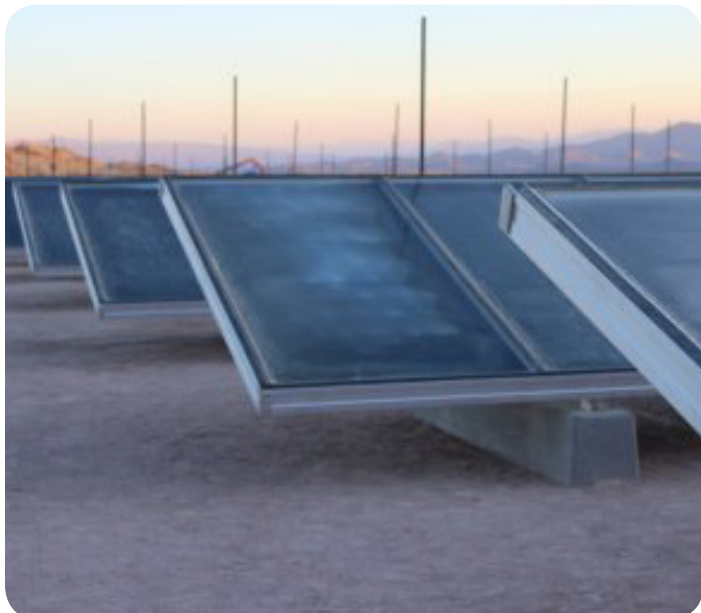
Colector Plano Con Cubierta (Img Google)
