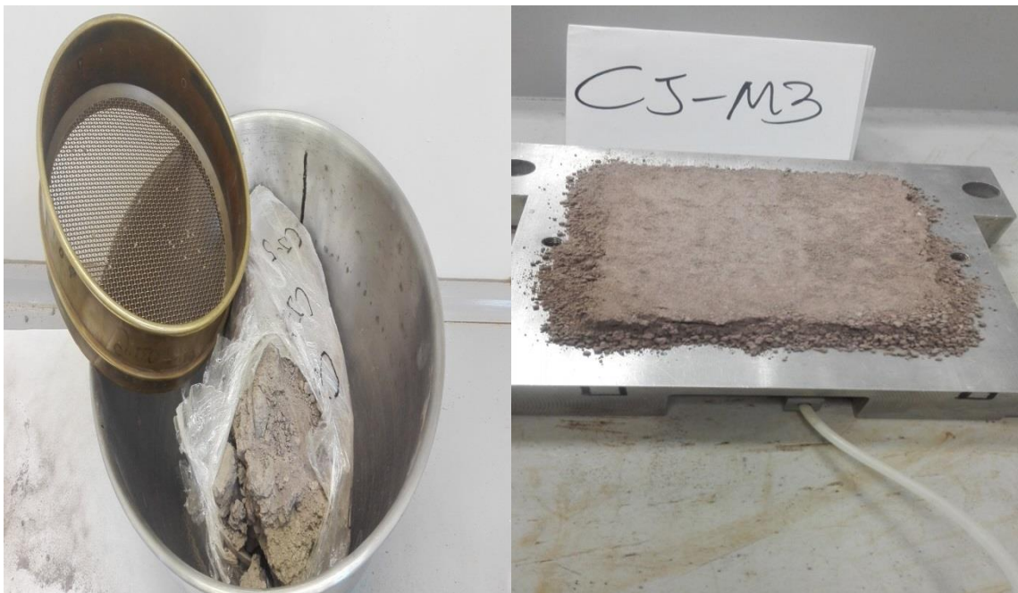
Figura 56: Izq: Bloque recolectado previo al tamizaje. Der: estado del material post ensayo monotónico.
