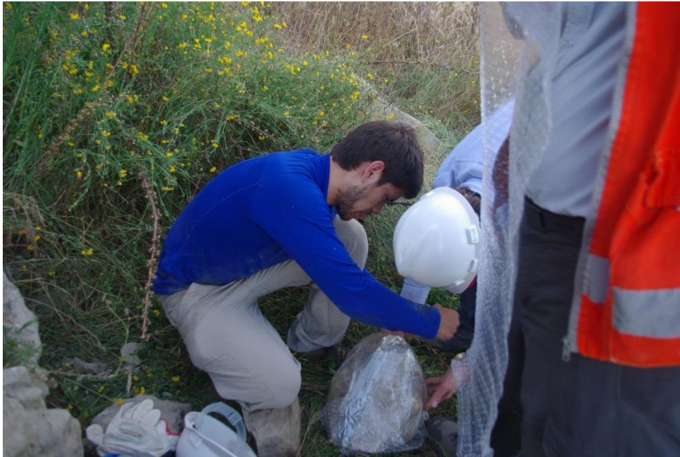
Figura 1: Embalaje de muestras enviadas al laboratorio de Remociones en masa de la Universidad de Durham (UK), para la realización de los ensayos de corte directo monotónicos y dinámicos.
