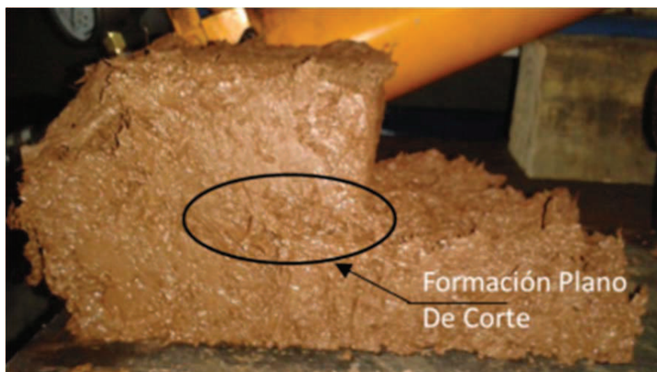
Figura 4.9: Formación de un plano de corte parcial. Fuente: Elaboración Propia.
