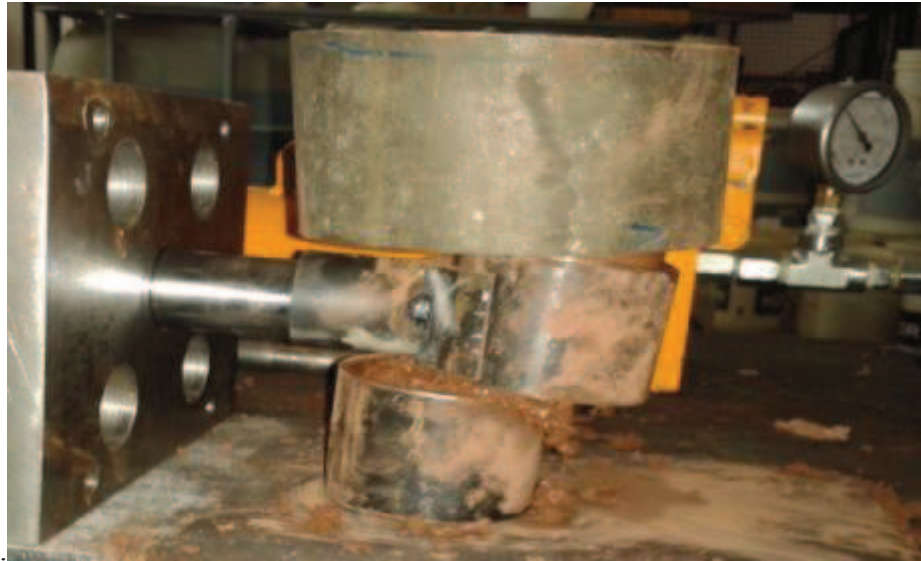
Figura 4.6: Carga aplicada a la celda de Jenike. Fuente: Elaboración Propia.
