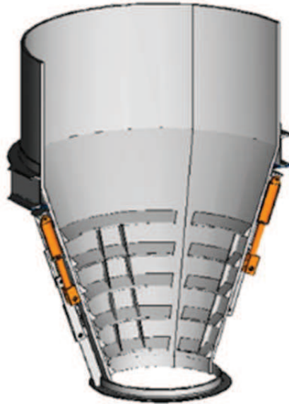
Figura 6.17: Mecanismo de arrastre vertical de la PBat. Fuente: Elaboración Propia.
