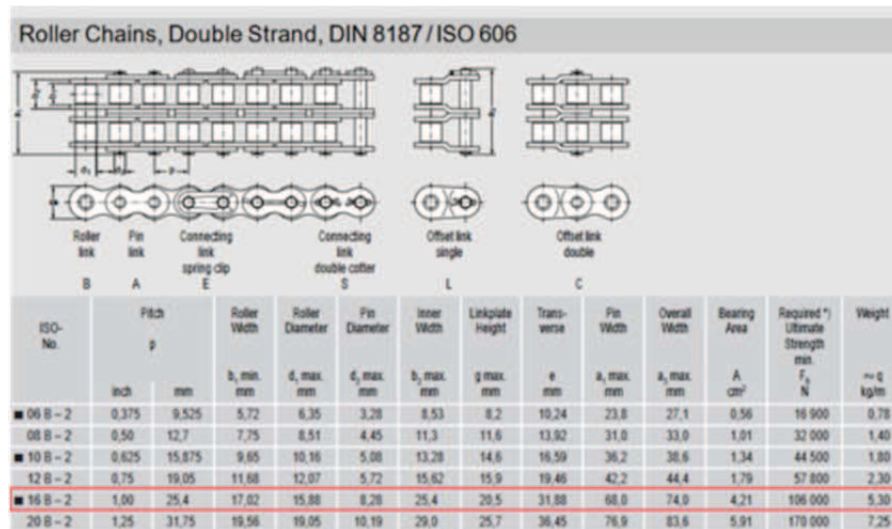
Figura 6.9: Descripción de cadena de transmisión DIN 8187 doble.
