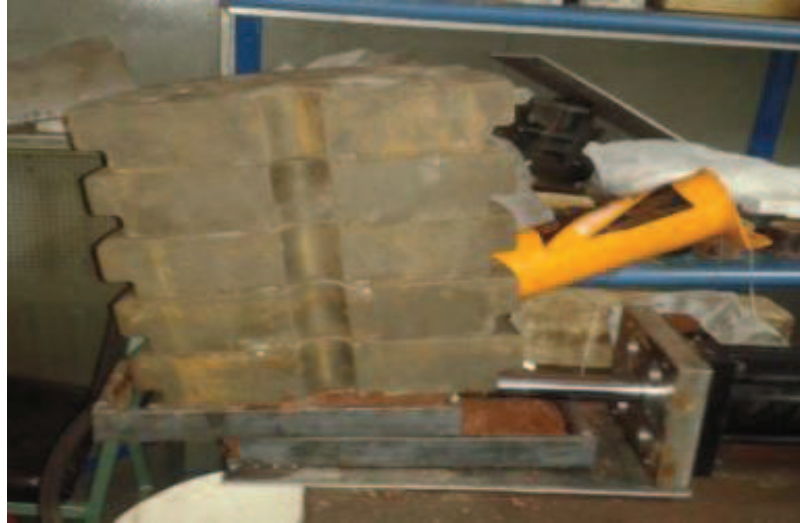
Figura 4.10: Volcamiento de pesos para carga vertical 95 kg.
