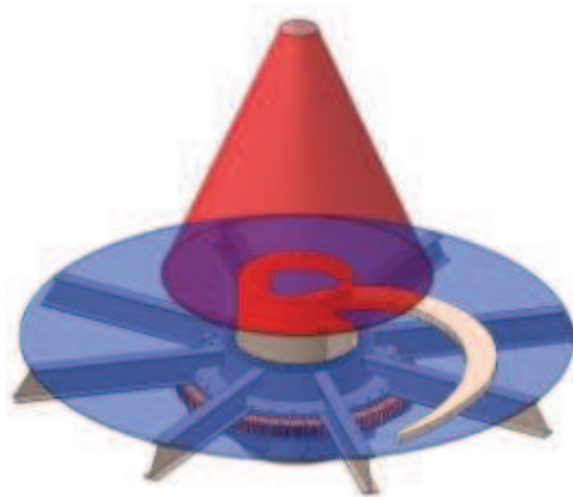
Figura 3.11: Descargador rotatorio de silo de fondo plano.
