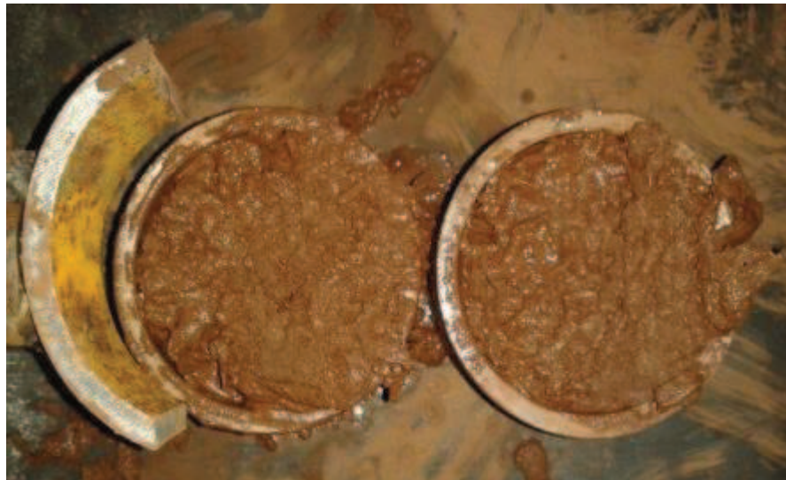
Figura 4.7: Zona de desplazamiento de material en celda de Jenike. Fuente: Elaboración Propia.
