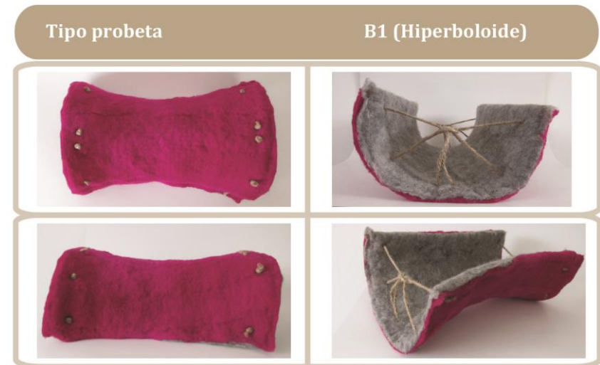
FIGURA 64 - PROTOTIPO B1 CON FIELTRO DE BORRA GRIS Y BRUTA BLANCA TEÑIDA, UTILIZANDO MOLDE CNC.
