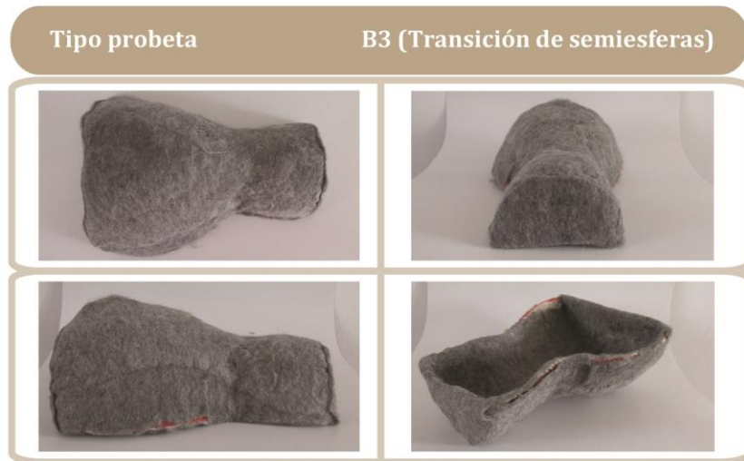
FIGURA 65 - PROTOTIPO B3 CON FIELTRO DE BORRA GRIS, UTILIZANDO MOLDE CNC
