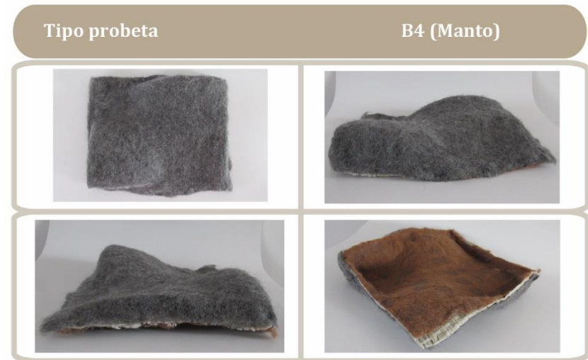
FIGURA 66 - PROTOTIPO B4 CON FIELTRO BORRA GRIS Y ALPACA VIRGEN UTILIZANDO MOLDE CNC
