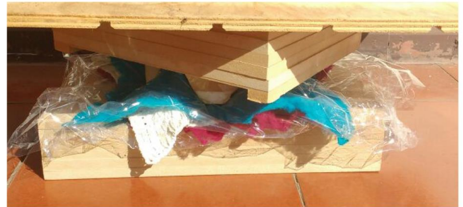
FIGURA 67 - CONFORMADO DEL PROTOTIPO C1 CON MOLDES MACHI-HEMBRADOS
