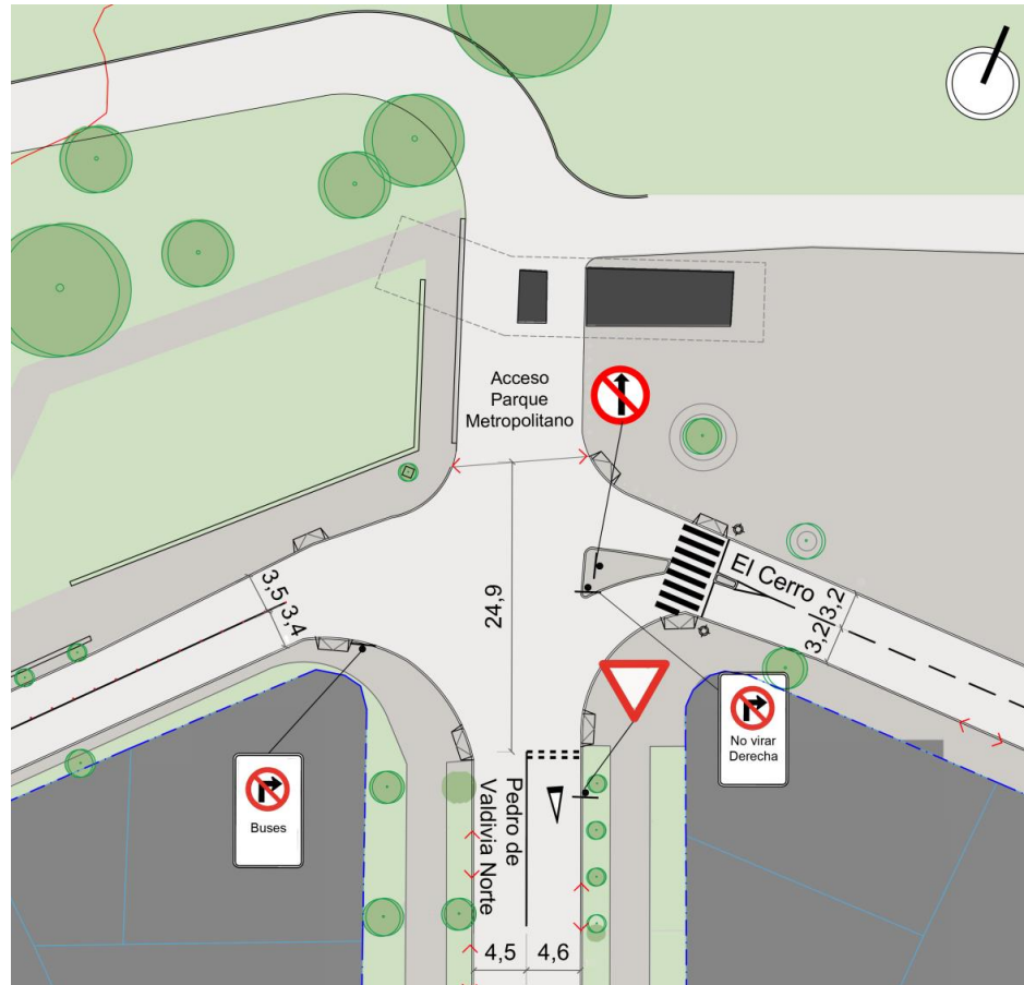
Figura 62. Señalización y demarcación, diseño vial actual..
