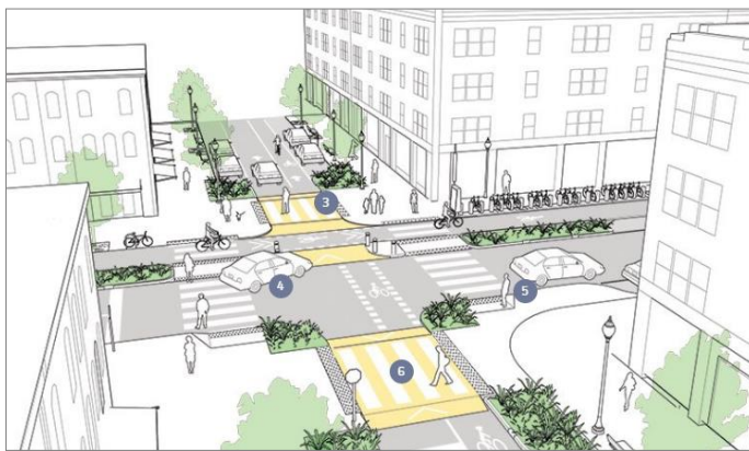
Figura 5. Intersección modificada con elementos de calmado de tráfico
