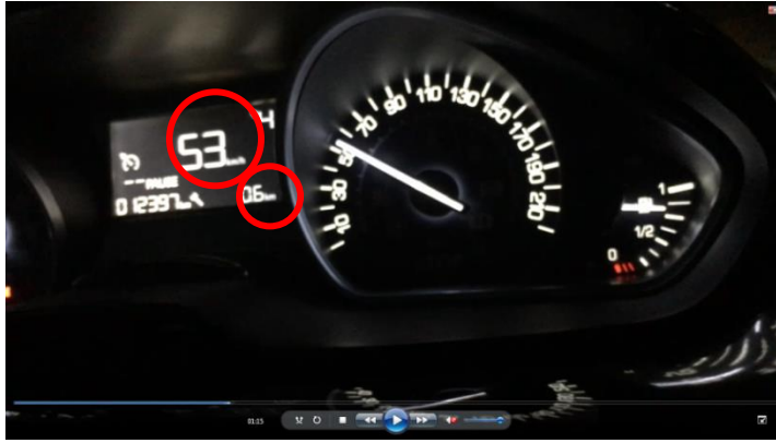
Figura 13. Imagen panel o tablero de instrumentos e indicador de velocidad y km recorrido por tramo en vehículo en movimiento.
