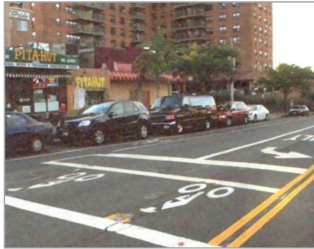
Figura 79. Demarcación zona de espera ciclista para viraje.
