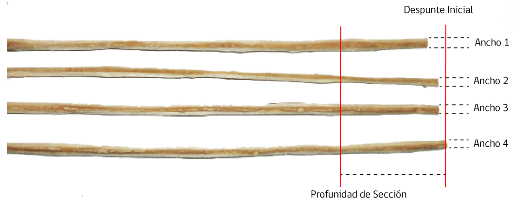
Imagen 21 . Método de medición de sección de vara.
