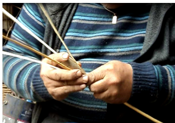
Imagen 59. Partido de vara con partidor artesanal. Fuente: propia.
