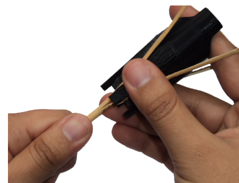
Imagen 75. Partido de vara con partidor 70 milímetros de largo.
