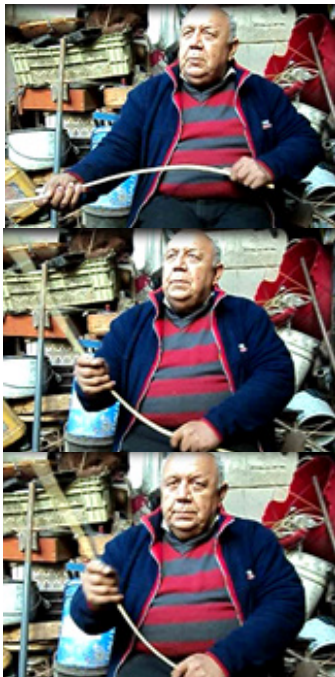
Imagen 13 . Rectificado de vara . Fuente: propia
