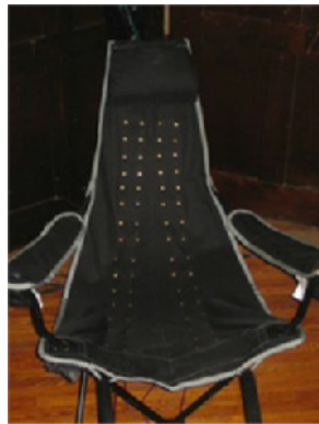
Prototipo emotichair de 16 altavoces integrados en respaldo y brazos de la silla.
