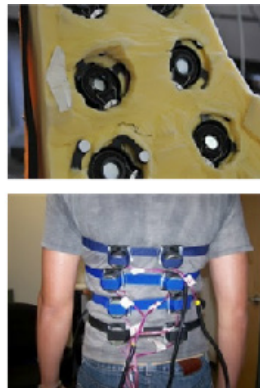
Prototipo emotichair de 16 altavoces integrados en respaldo y brazos de la silla.
