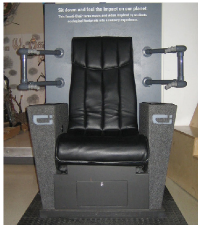
Prototipo emotichair de 14 altavoces y sistema de balanceo para sonidos graves.
