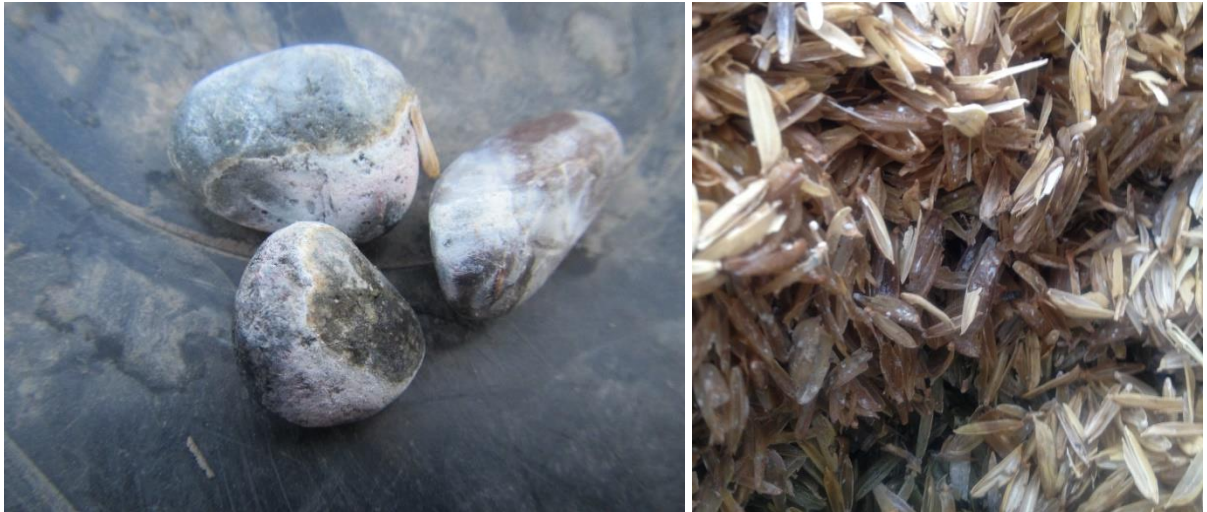
Figura 36. Grava y cáscara de arroz con precipitado blanco. La figura de la izquierda se presenta en todos los humedales, mientras que la segunda pertenece a una celda de control.
