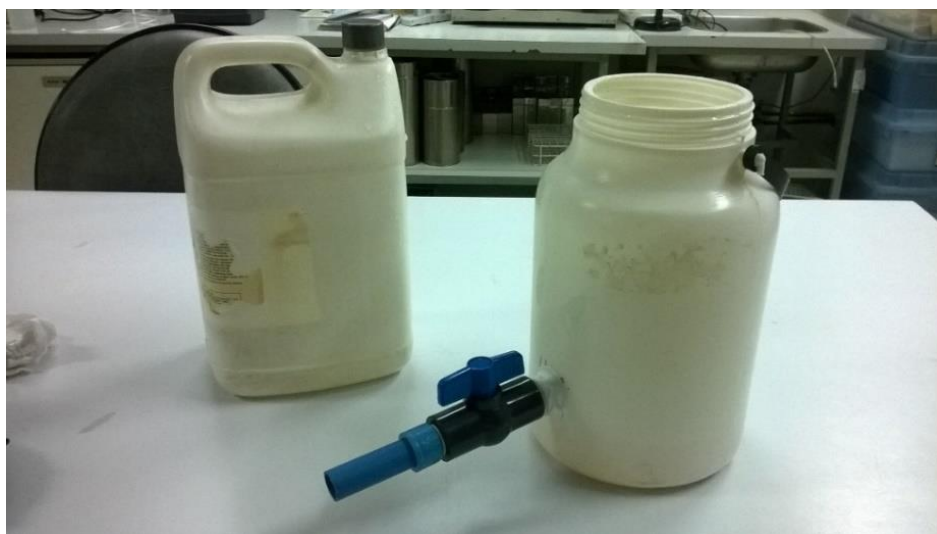
Figura 7. Derecha: Envase sedimentador. Izquierda: Receptáculo para la fase líquida.
