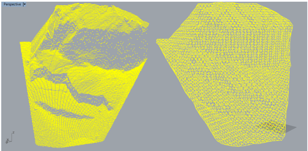
Figura 4.10: Nube de puntos (izquierda) y la malla de triangulaciones corregida (derecha) del talud (Figura 4.9). Vista en perspectiva.
