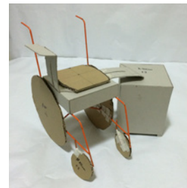
Imagen 87 a 92: Maqueta funcionamiento propuesta 1:3. Fuente: Elaboración Propia
