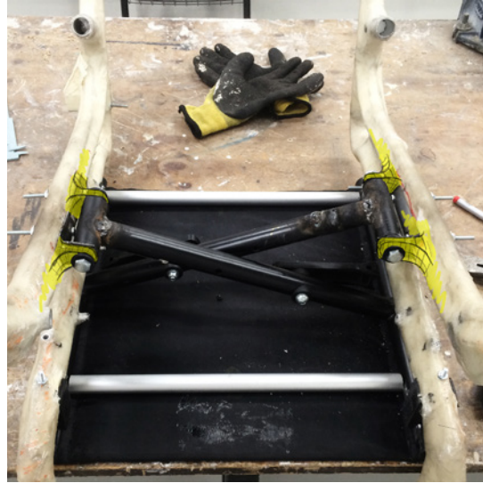
Imagen 69 (←) 70 (↑): Vínculo de uniones al marco para el rotomoldeo Fuente: Elaboración Propia
