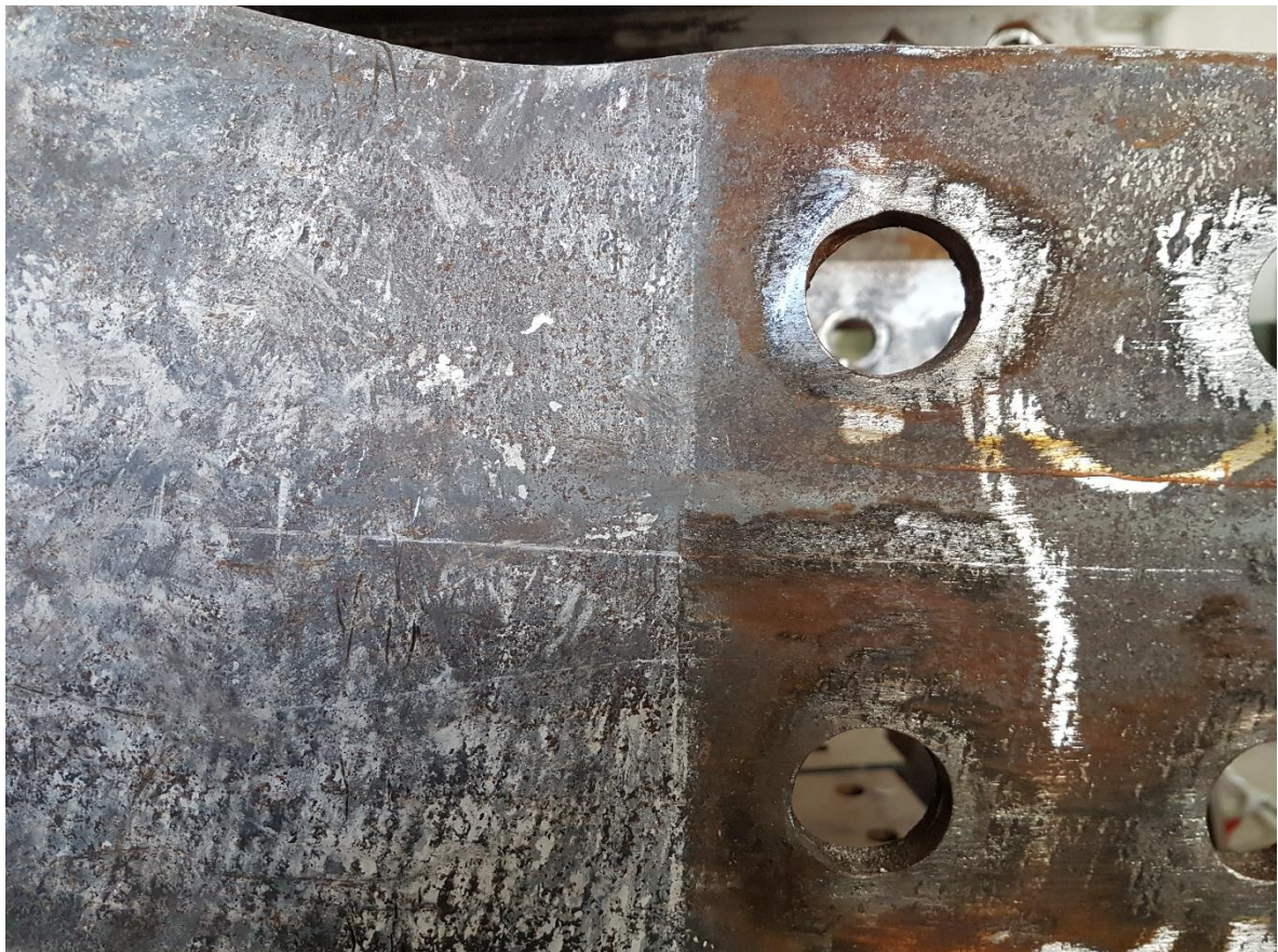
Figura 5.42: Aplastamiento experimental del ala de la viga del espécimen DBT 5 (Salas, 2016)
