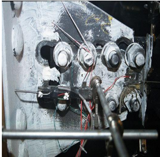
Figura 1.3: Fractura por bloque de corte en la T Stub (Smallidge, 1999)
