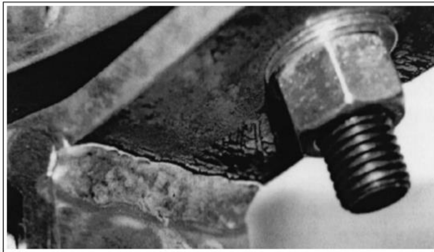
Figura 2.14: Fotografía del apalancamiento del perfil soldado - Probeta 12 (Piluso et al, 2001)
