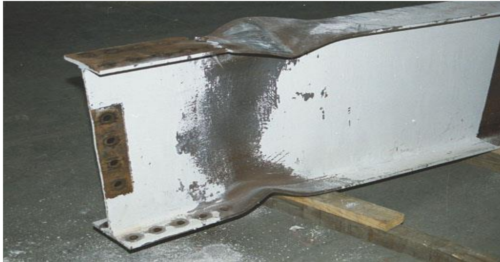
Figura 3.19: Fractura del área neta del ala de la viga posterior al proceso de pandeo post fluencia para FS07 (Smallidge, 1999)
