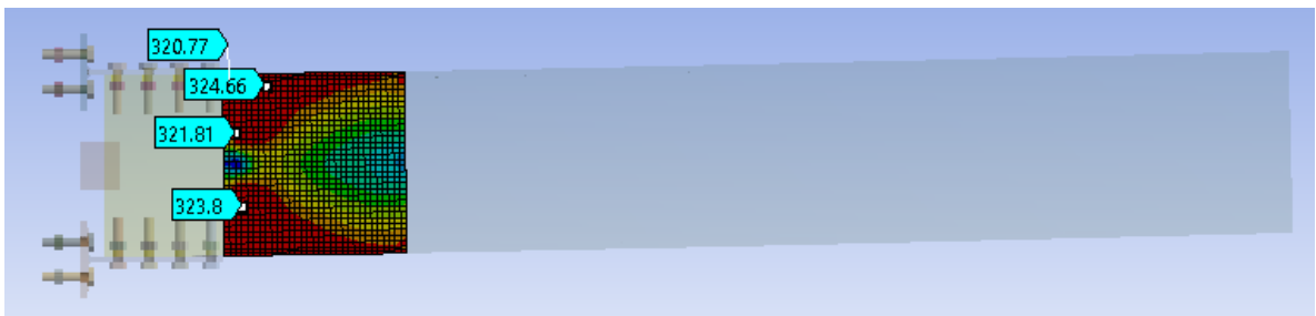
Figura 5.6: Estado tensional de von Mises de la zona de plastificación en la viga para el espécimen DBT 1.
