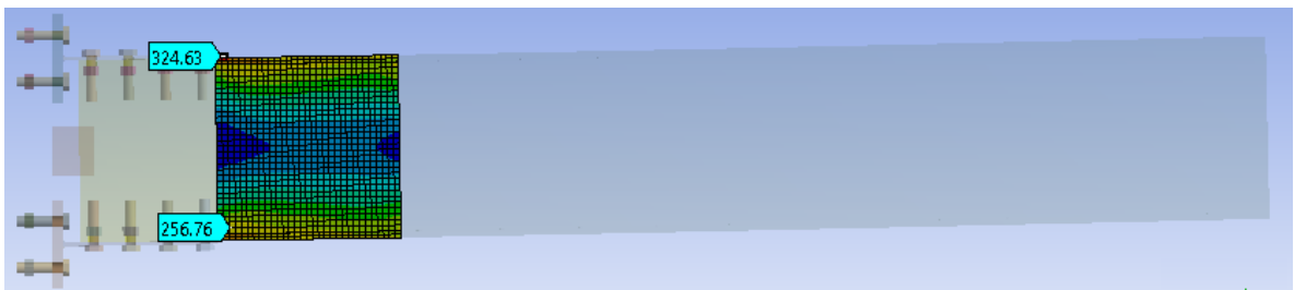
Figura 5.18: Estado tensional de von Mises de la zona de plastificación en la viga para el espécimen DBT 2.
