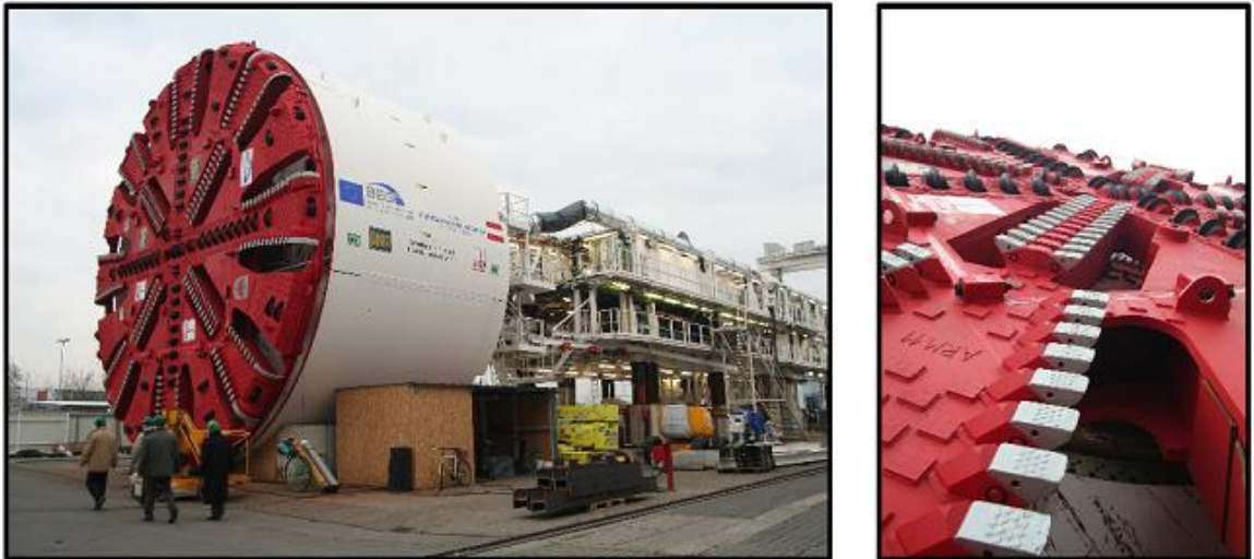
Figura 6: Máquina tuneladora. La rueda tiene un diámetro de 13.3 m. (Imagen obtenida de S. Jetschny, «PhD. Dissertation. Seismic prediction and imaging of geological structures ahead of a tunnel using surface waves.» [11])
