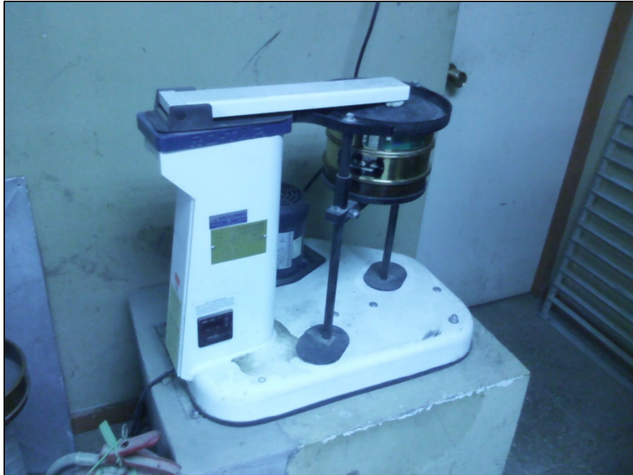
Figura 4.6 Equipo mecánico para proceso de tamizado - Laboratorio de Vialidad región de Aysén.
