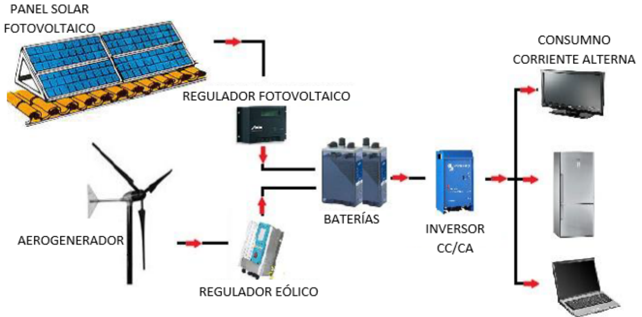
Figura 3.19: Diagrama de central mixta eólica – fotovoltaica [10].
