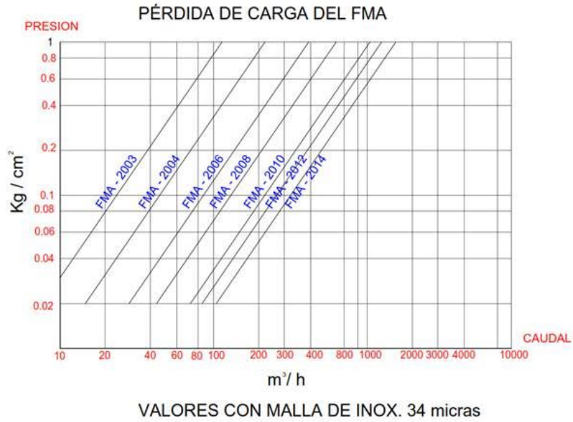
Figura D.0.1: Diagrama de pérdida de carga para filtros basket con malla de INOX. 34 micras
