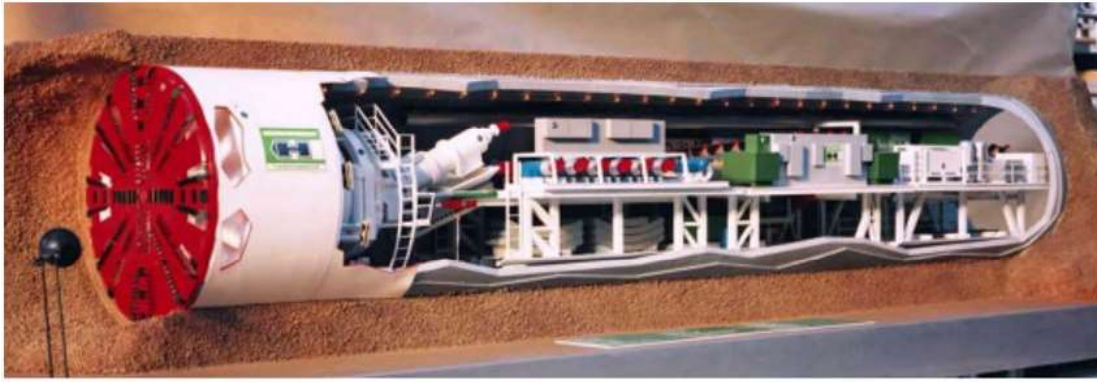
Figura 3.12: Maqueta de un escudo tipo EPB de frente cerrado.
