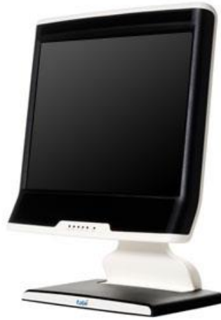
Ilustración 3: Dispositivo eye-tracker con tecnología infrarrojo.
