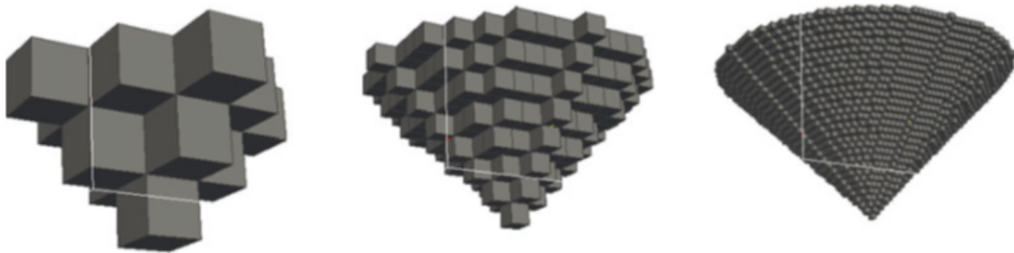
Figura 4: Aproximación de la geometría de extracción basado en distintos criterios para definir el molde de extracción. Por ejemplo, a 45^\circ y considerando distintos niveles de precedencias: dos, siete y veintinueve niveles sobre el bloque ubicado en el vértice y al cual se quiere ganar acceso. Puede verse cómo el número de niveles afecta la forma del pit. Fuente: Espinoza et al. (2013a).
