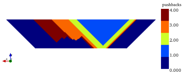
(f) vista en sección pushbacks, instancia 3
