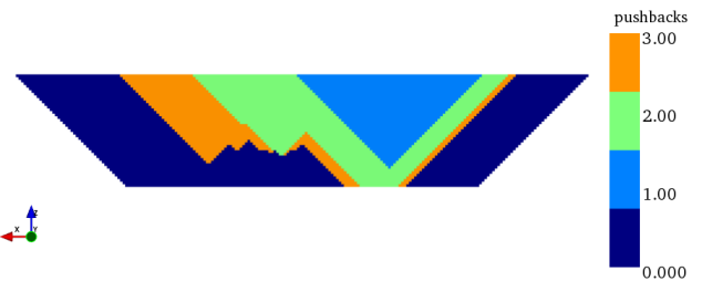
(f) vista en sección pushbacks, instancia 6
