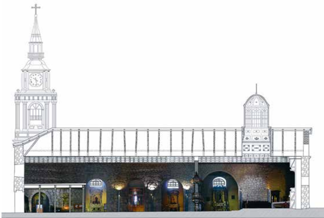
FIG 3 Corte fotogramétrico longitudinal iglesia San Francisco. Nave central original. / Photogrammetric longitudinal section San Francisco Church. Original central nave. Escala / Scale 1:500. Fuente / Source: FONDECYT N° 11130628
