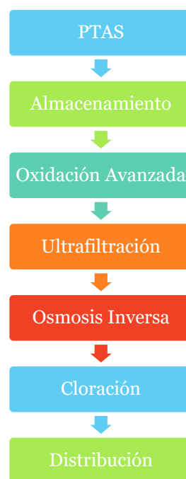
Figura 11: Diagrama de bloques propuesto para el reciclaje de aguas
