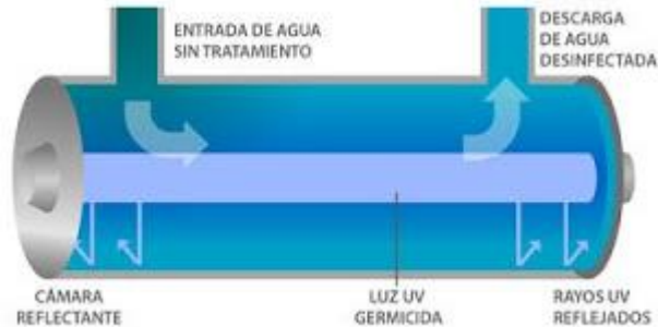
Figura 13: Esquema desinfección por radiación UV[37]
