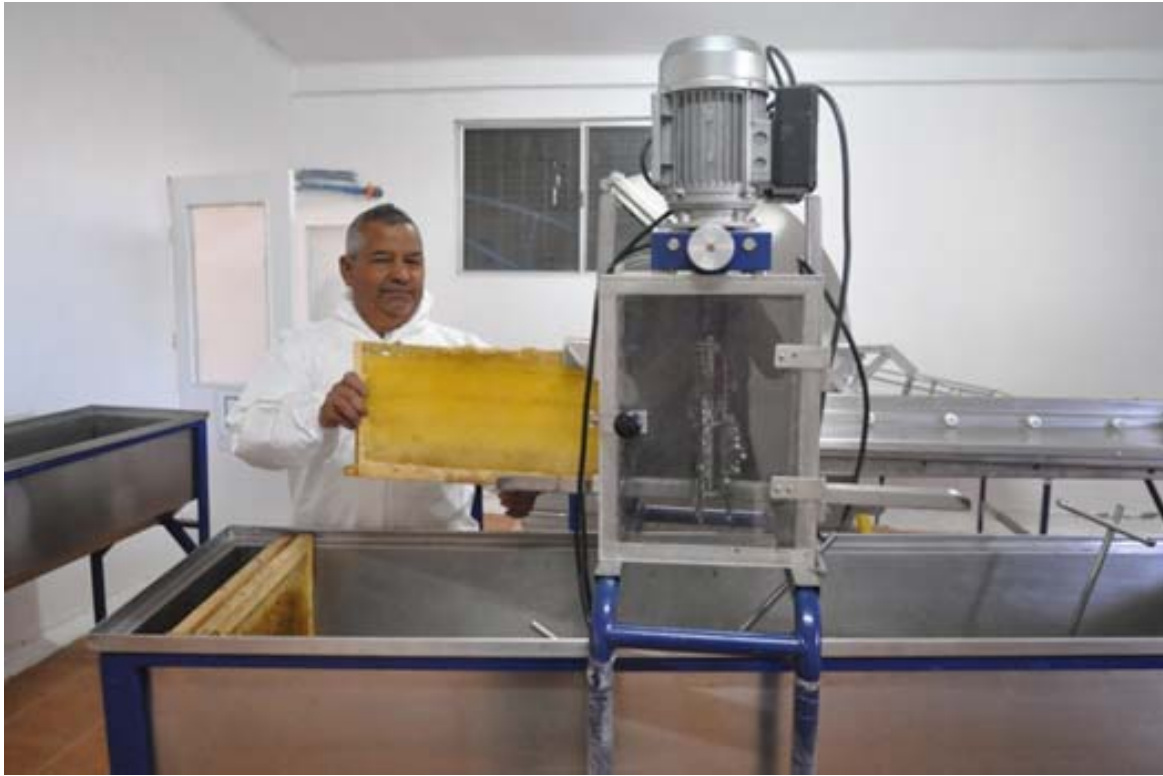
Figura 3. Planta de Extracción de Miel. Fuente: FMLP.
