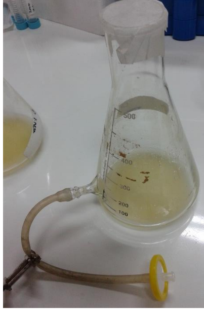
Figura 40 Matraz con sistema de extracción de muestras a través de una manguera y jeringa.
