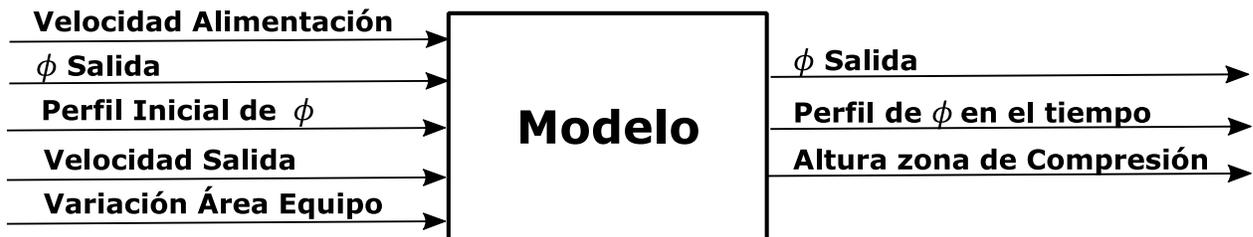
Figura 19: Variables modelo fenomenológico 1 dimensión con viscosidad despreciable, y área variable. Elaboración propia.
