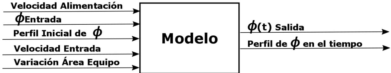
Figura 17: Variables modelo fenomenológico 1 dimensión con viscosidad y consolidación despreciables, y área variable. Elaboración propia.
