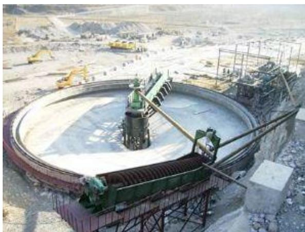
Figura 10: Espesador de tracción periférica [30].
