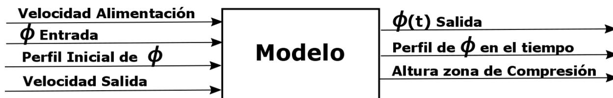
Figura 15: Variables de entrada y de salida modelo fenomenológico en 1 dimensión con viscosidad despreciable. Elaboración propia.
