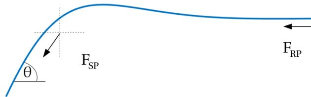
Figura 2.3: Descomposición del *Slab-pull* ( $F_{SP}$ ) y *Ridge-push* ( $F_{RP}$ ) en la placa. La primera tiene componentes en la horizontal y la vertical, mientras que la segunda tan sólo en la horizontal.
