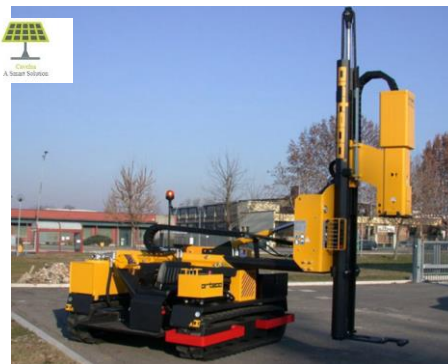
Figura N°2: Máquina Hincadora de Pilotes marca Orteco.
