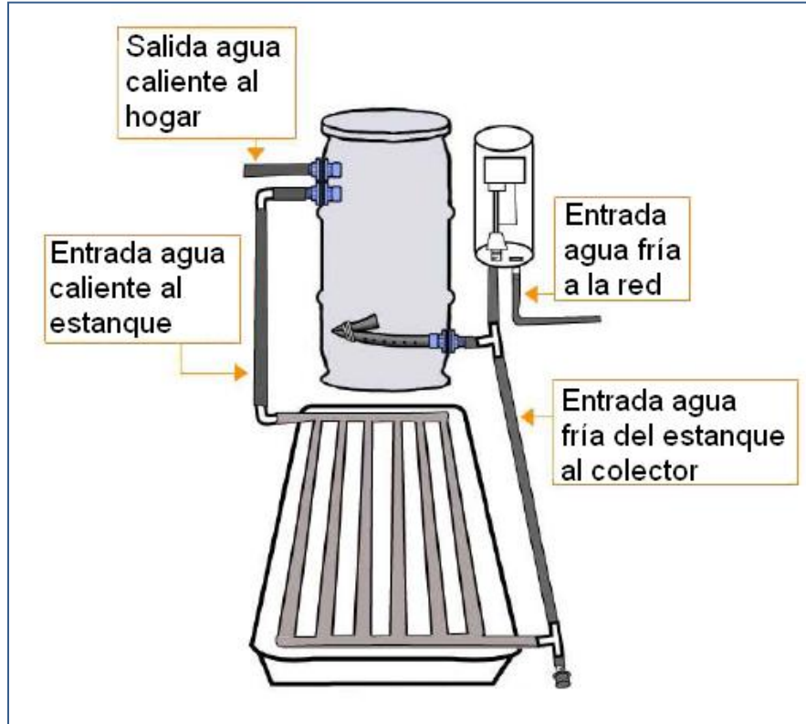
Figura 5. Esquema Colector Solar Térmico con Aplicación Directa.
