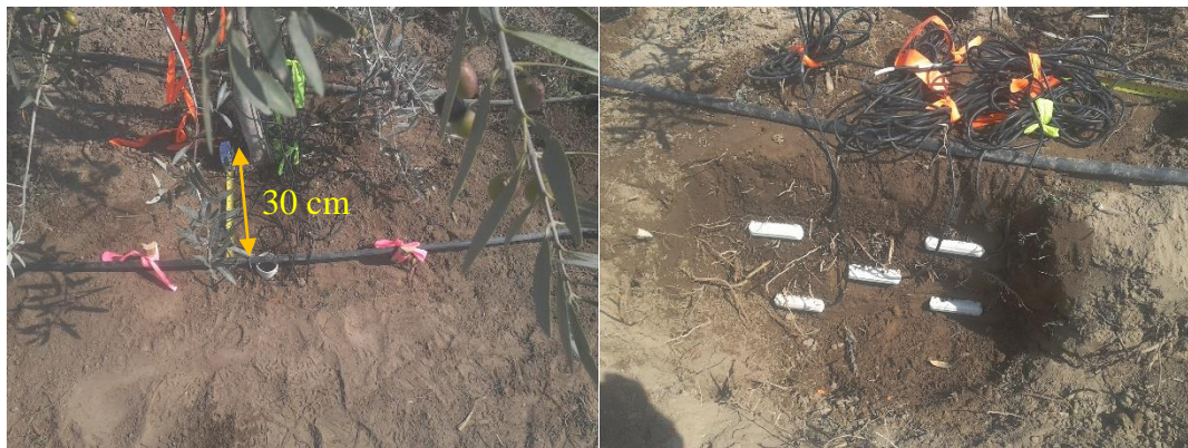
Figura 5. A la izquierda se observa la separación de 30 cm desde la base de la planta a la línea de goteros. En la imagen de la derecha, observando desde arriba, se aprecia la disposición de los FDR a las distintas profundidades, comenzando la primera línea de FDR (izquierda a derecha) justo bajo el emisor.
