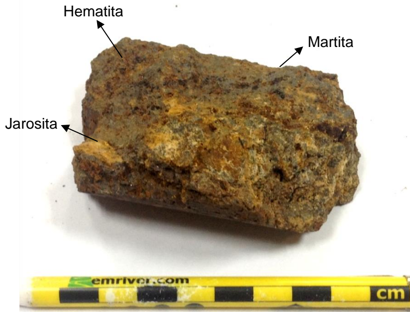
Figura 5: Óxidos de hierro y martitización. Muestra ALD-02, sondaje ALD1335, profundidad 81.15 metros (455 m.s.n.m).
