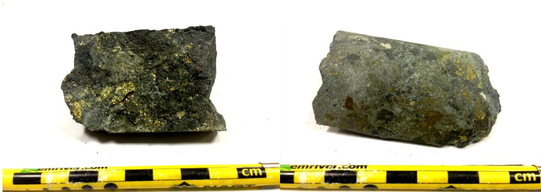
Figura 8: Unidad de andesita mineralizada con brecha magnetita-actinolita±sulfuros. Muestra ALD2-03, sondaje ALD 1215, profundidad 283 metros (262 m.s.n.m.)
