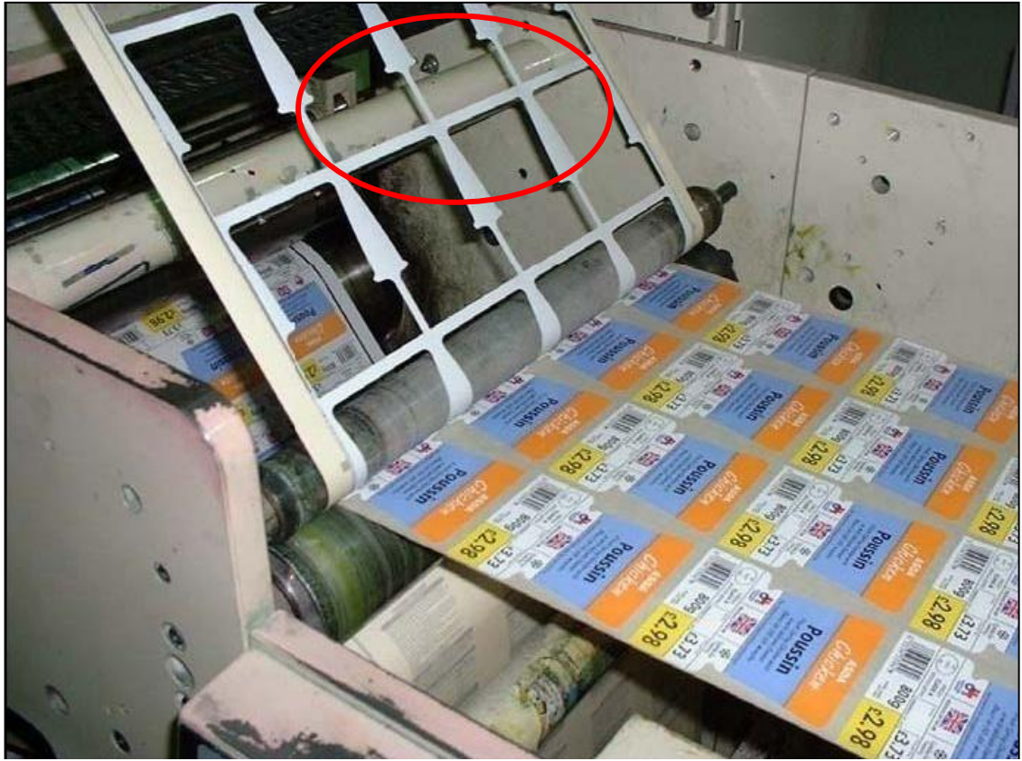
Figura 2: Proceso de fabricación de las etiquetas autoadhesivas, donde se separa parte del residuo. (Fuente: Määttänen, 2008).
